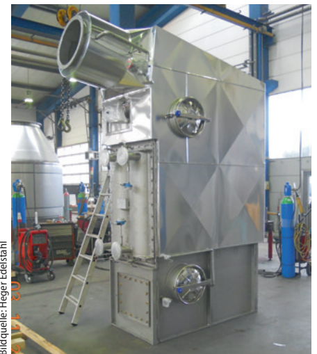
HEG-EC-0150 von Heger Edelstahl: Nicht nur Wärmerückgewinnung, sondern auch Staubabscheidung
