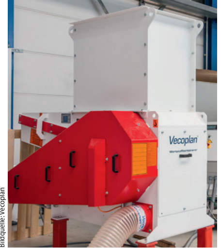
Mit der kompakten VAZ-Baureihe können Tischler und Zimmerleute zuverlässig Resthölzer zerkleinern
